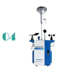
BAM1006 Continuous Particulate Monitor adota o princípio da atenuação dos raios β para medir a concentração de partículas. O resultado é preciso e confiável. Consiste em três componentes básicos: o hospedeiro do instrumento, a cabeça de corte e o sistema de amostragem.
