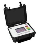
ZWIN-AQA1008 Portable helium oxygen Analyzer (Diving) é um analisador portátil de três misturas projetado para garantir a mistura correta de hélio, oxigênio e nitrogênio, que é um instrumento de análise de gases de mergulho fácil de operar que pode analisar misturas de gases, corrige automaticamente as condições ambientais e elimina o risco de cálculo manual erros. possui um grande LCD no painel traseiro que é fácil de ler mesmo em condições de pouca luz e fornece informações adicionais.
